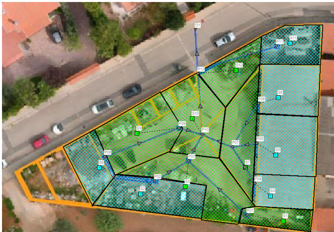
Figura 8 – Superfici scolanti della nuova rete in progetto
